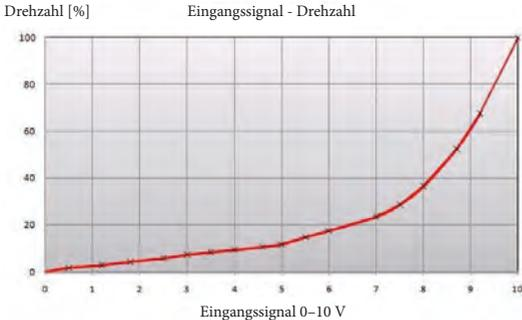
Das Eingangssignal ist direkt proportional zum Wirkungsgrad am Rotor, wodurch Eingangssignal und Drehzahl der Kennlinie in nebenstehendem Diagramm entsprechen.
