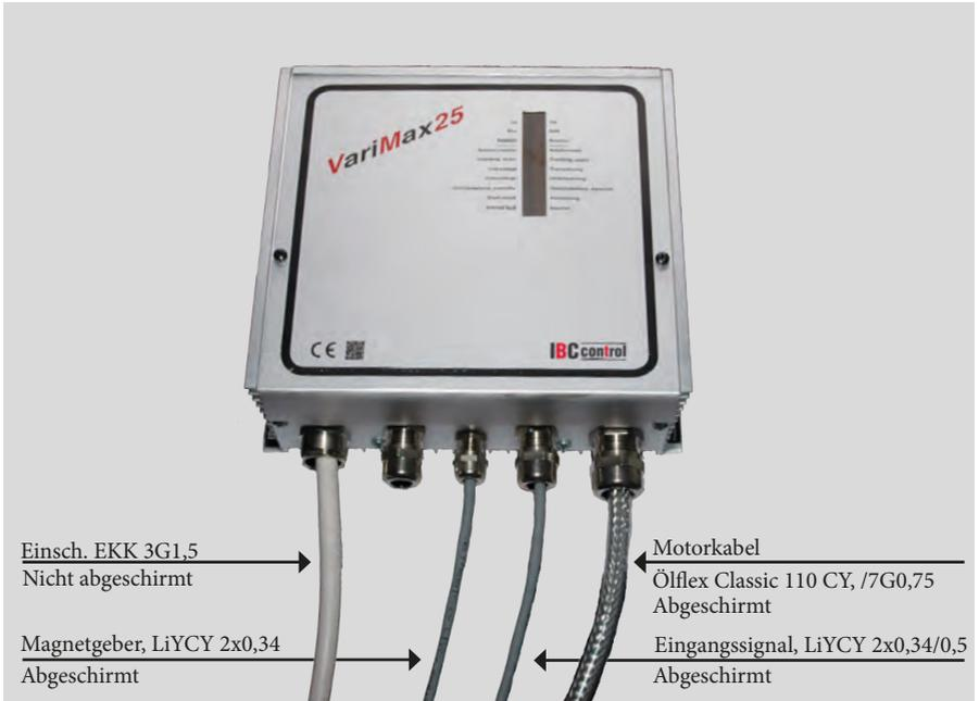
EMV-Verschraubung ist für abgeschirmtes Kabel zu verwenden.
